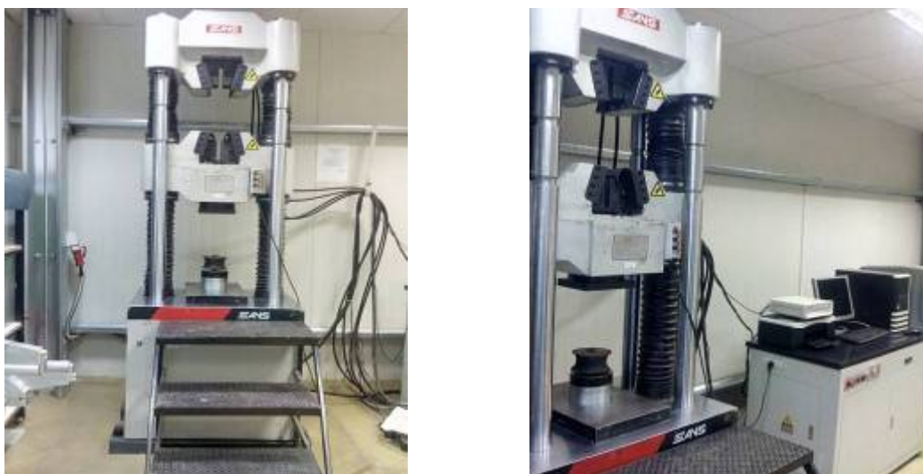
Fig. 5.14 Presa de încercare la compresiune SANS DCS 300
